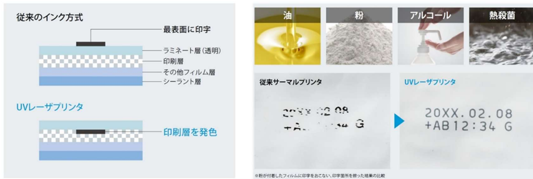
(図1-2 従来のインク方式とUVレーザープリンタの違い)
